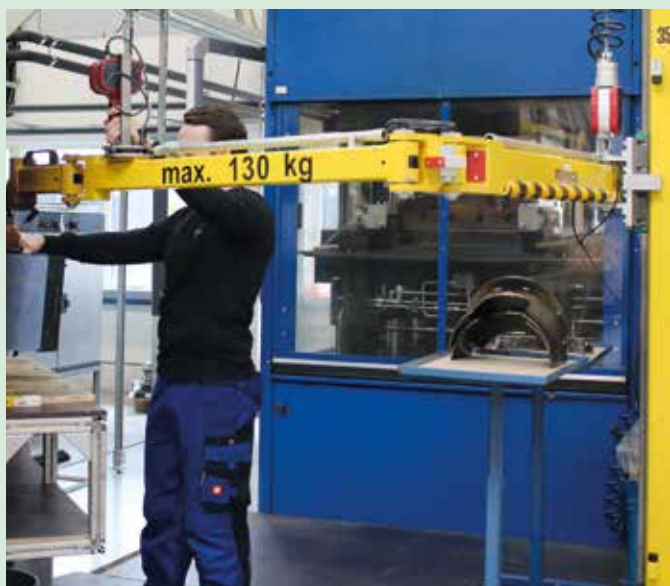
Alle unsere Maschinen sind ab einer definierten Größe mit einem Balancer ausgestattet, der es den Bedienern ermöglicht, nahezu kraftfreie, schwere Bauteile zu transportieren.
