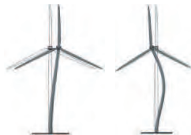
Die erste und zweite Turmeigenfrequenz einer Windenergieanlage.
