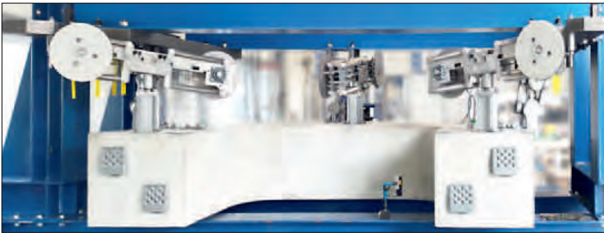
Bild 6a und b zeigen ein ausgeführtes Beispiel für einen 2. Turmeigenfrequenz-Pendeltilger, der sich kompakt in die bestehende Einbausituation des Turmes einpasst.
