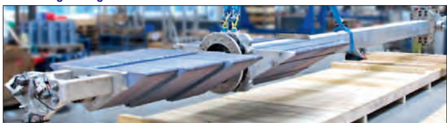
Bild 5: Ein großer 1. Turmeigenfrequenz-Pendeltilger für eine 6 MW Offshore Windenergieanlage
