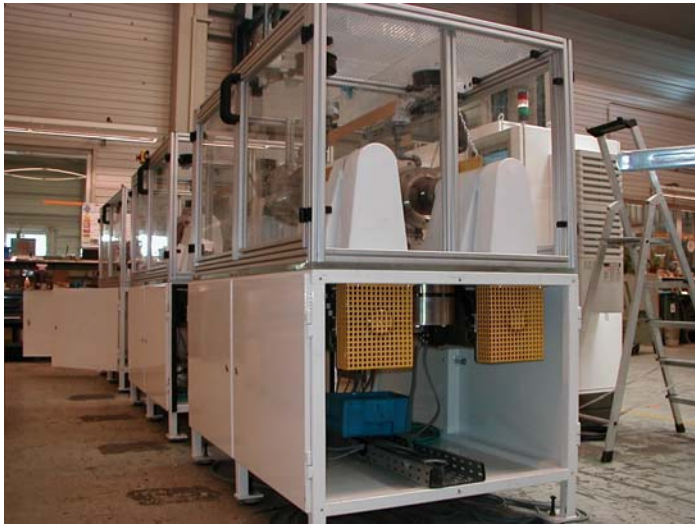
Bild 8: Tilger zur Schwingungsreduzierung in Prüfmaschinen
