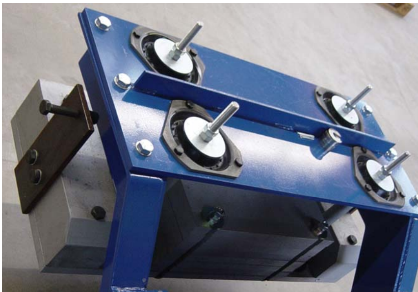
Bild 13: Tilger zur Reduzierung von Rotorblattschwingungen - Prüfaufbau
