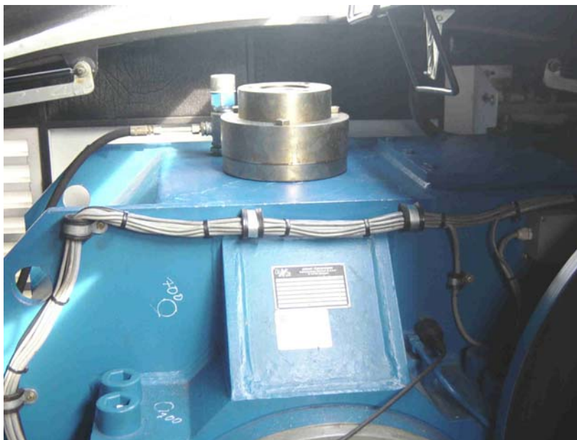
Bild 16: Tilger zur Körperschalloptimierung an einem Getriebegehäuse
