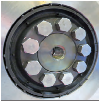
Bild 17 : Mit neun M16-Schrauben vorgespannte Buchse
