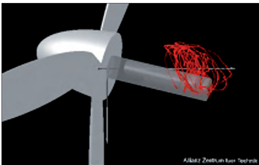
Bild 3 : Triebstrang der 5 MW-Anlage BARD 5.0 mit einem Hauptlager (Generator nicht dargestellt), Pfeil kennzeichnet Abstützung durch Elastomerhydraulisches Getriebeauflager. Quelle Bard Emden Energy.
